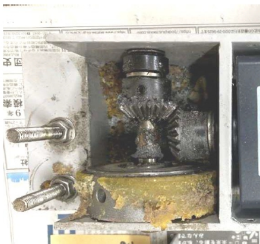
図3：ドーム回転駆動輪の故障
