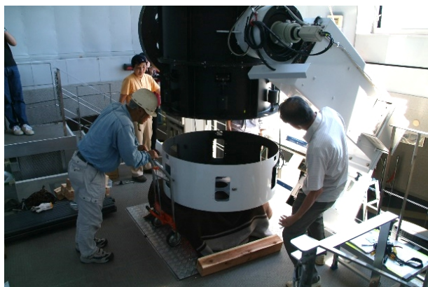
主鏡再メッキのための取り外し作業
